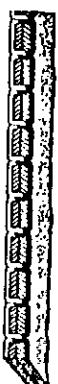
Bei einem einwandfrei eingezogenen Stich liegen die Schlingen des Ober- und Unterfadens genau in der Mitte des Materials.
